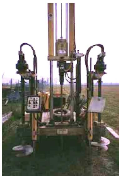
Figura 2.12 – Equipamento de cravação mecânico para o ensaio de cone
