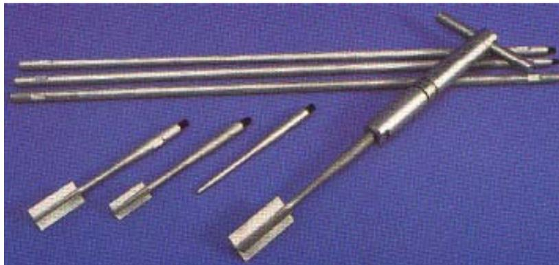
Figura 2.16 – Palhetas empregadas no ensaio
